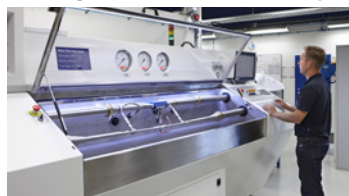
Durchflussprüfstände für Hydrauliköl und Wasser, bis zu 300l/min.
