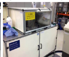
Impulsdruck-Prüfstand bis zu 4.000 bar
